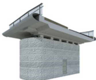
Pile intermédiaire (@Strates).
