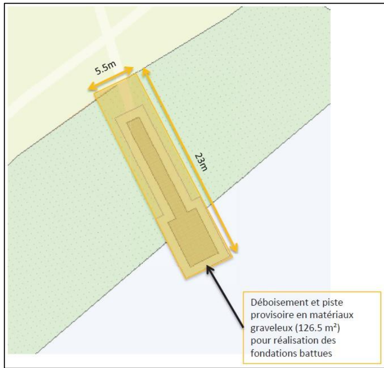
Fig. 28. Schéma de la zone déboisée pour l'emprise du ponton Sud
