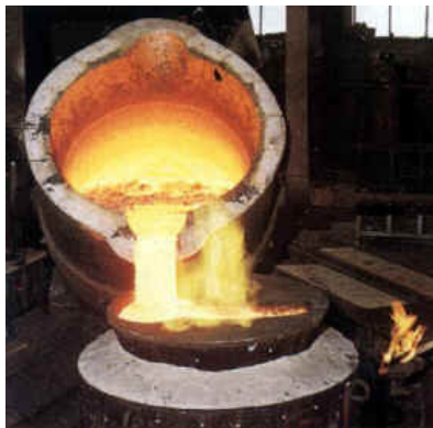
Coulée d'une cloche
