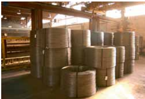
La matière première de KP1 : le fer à béton... ici en bobine.
